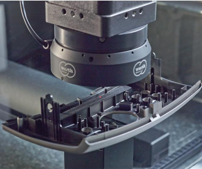
Bild 4: Der patentierte Werth Laser Probe ist in den Strahlengang des Werth Zooms integriert
